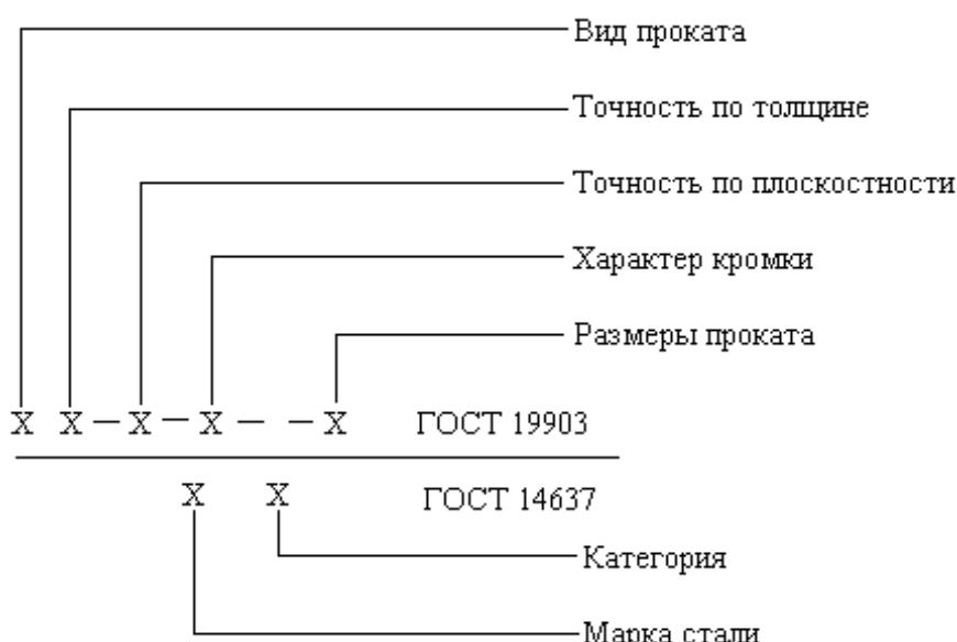
Примечание. Параметры и характеристики проката приведенные в схеме, если они не указаны в заказе, устанавливаются изготавителем и в обозначении не приводятся.
